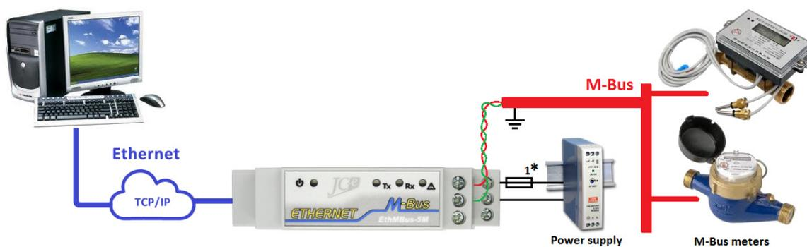
Doporučené zapojenie prevodníka s M-Bus zar., napájacím zdrojom a pripojením do siete Ethernet.
